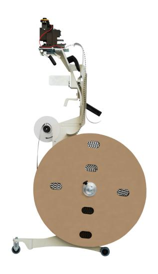
**ToolingShuttle 61**Mobile Schnellwechsel-Einheit für CrimpCenter
